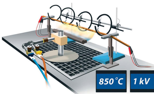
Prüfung gemäß EN 60331 (850°C 1kV)
