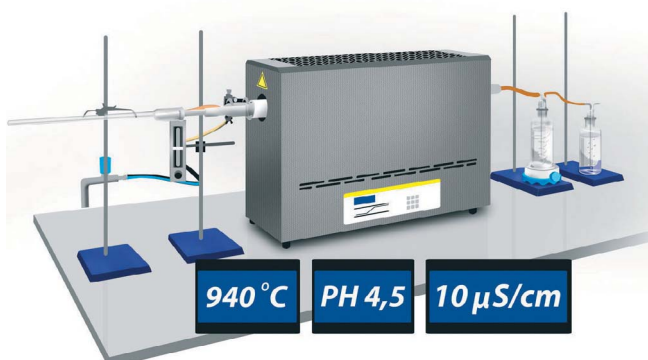
Messung der Korrosivität der Brandgase
